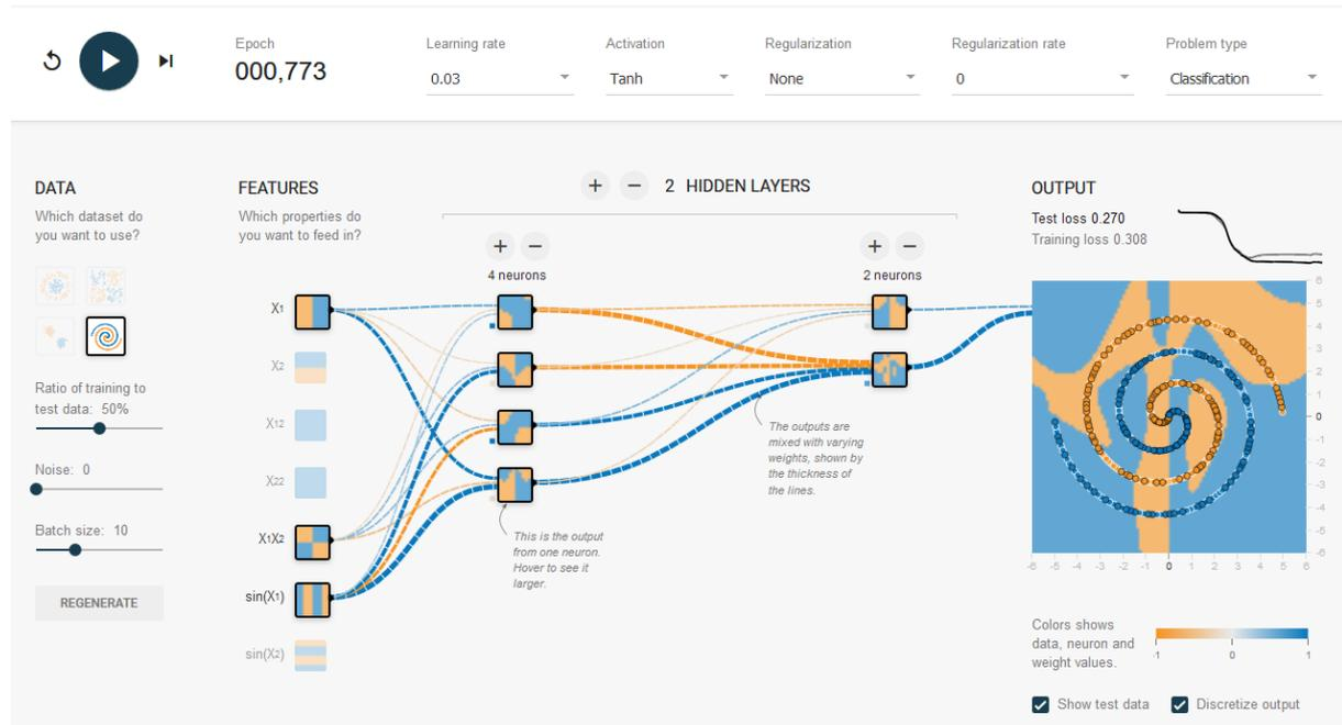
Eine Demonstration des Lernens lässt sich direkt im Browser ausführen. Man wählt ein Datenformat Input- Hidden- und Output Units. Die Anzahl der Units auf einer Ebene lässt sich genauso verändern wie die Anzahl der Hidden Unit Ebenen. Die Farben deuten negative und positive Werte an. Im Laufe der Iteration sieht man, wie bestimmte Pfade verstärkt und andere abgeschwächt werden und das Ergebnisbild sich verändert.
