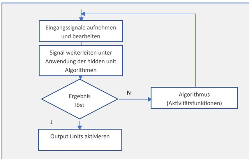
Im ersten Vortrag zum Thema Algorithmen und Zufall war bereits ein einfaches Blockdiagramm zu sehen, dass die Lernfunktion eines neuronalen Netzes darstellt. Mit dem Instrumentarium aus Abschnitt 3.1 wissen wir nun etwas genauer, was ein hidden unit Algorithmus ist und die Aktivierungsfunktion
