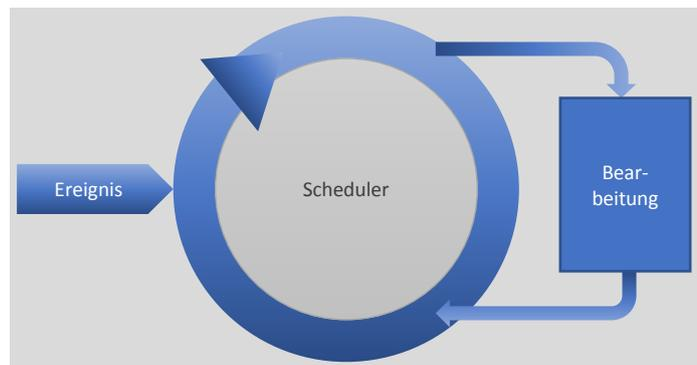
Dieses einfache Modell mit einem Ereignis und einem Bearbeitungs-Algorithmus (Task) unterscheidet sich kaum von einem Algorithmus, der nach dem Start nur einfach abläuft und dann stoppt. Der Sinn des Aufbaus erschließt sich aber, wenn viele Ereignisse zufällig eintreten, die verschiedene Bearbeitungsprozesse erfordern.
